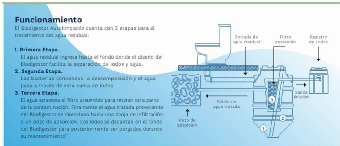
**Imagen II.18** Funcionamiento del Biodigestor Autolimpiable
