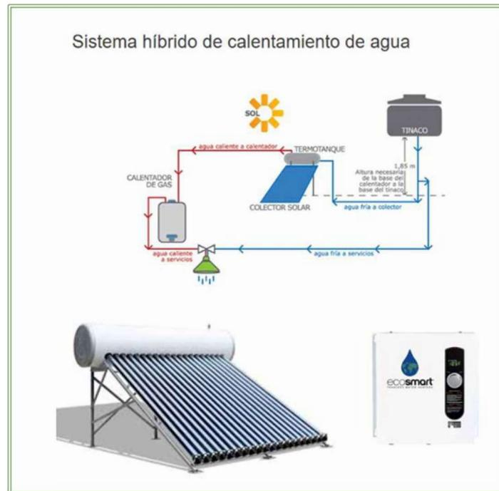
**Imagen II.16** Sistema híbrido de calentamiento de agua
