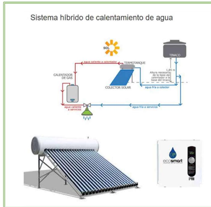
**Imagen II.15** Sistema híbrido de calentamiento de agua
