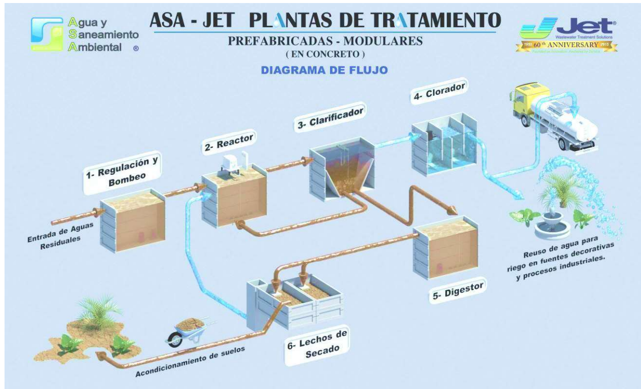
Figura II-4 Diagrama de flujo del proceso de tratamiento de la PTAR del Proyecto.
