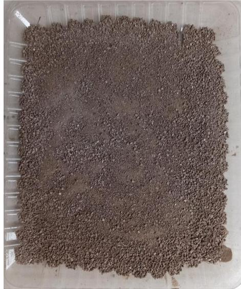
Figura IV. 28 Muestra de suelo tomado a 1.8 metros de profundidad.
