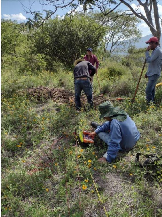
Figura IV. 36 .- Geotecnia pozo 2, sondeo eléctrico vertical 2, explorado a 50 metros.
