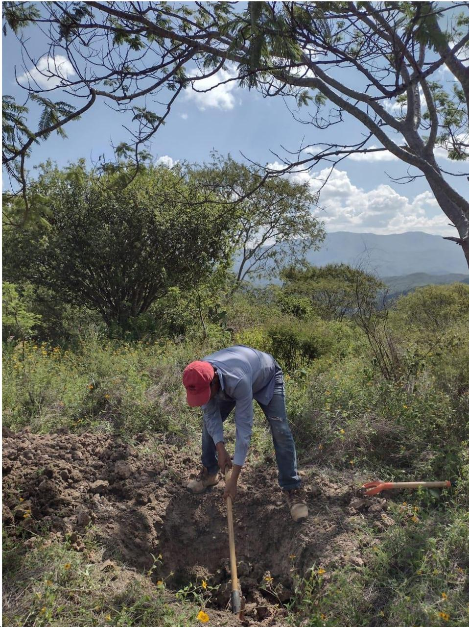
Figura IV. 37 .- Excavación de pozo 2 a cielo abierto, muestra obtenida a 1.7 metros
