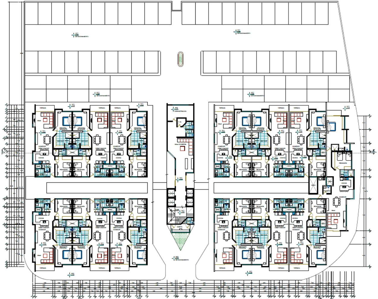
**Figura II.9. Detalle de planta arquitectónica de planta baja del proyecto.**
