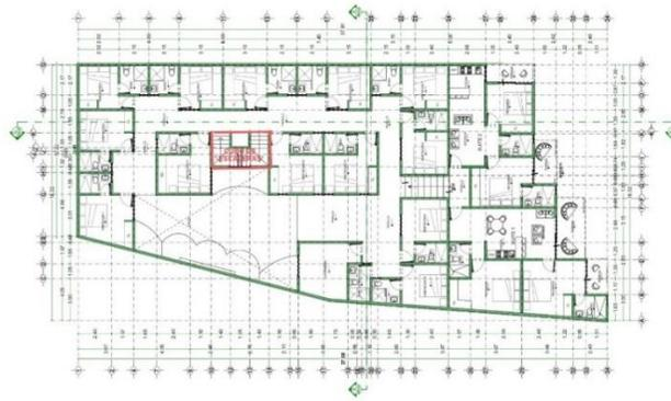
Figura II.65. Cubo de escaleras-Segundo Nivel
