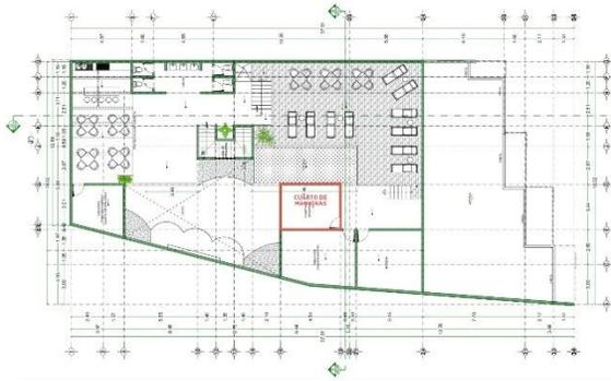
**Figura II.76.** Cuarto de máquinas-Azotea o terraza
