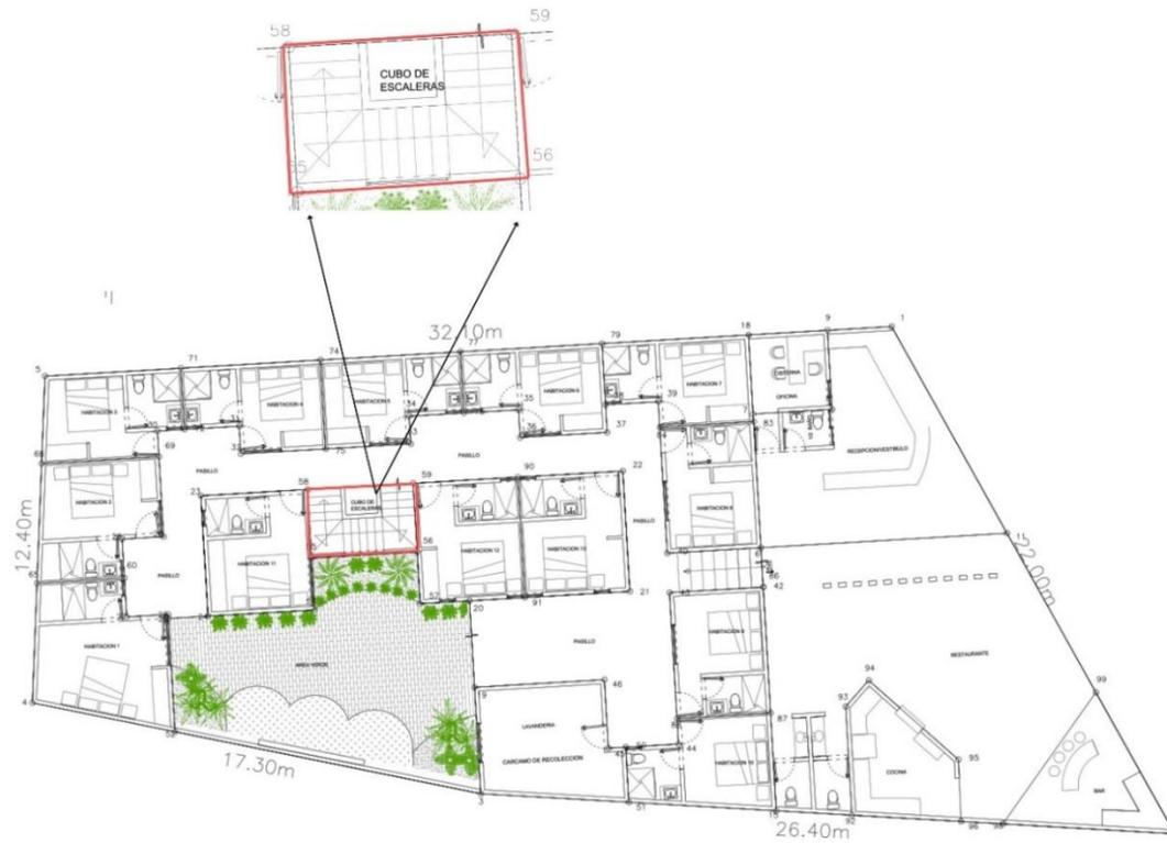
**Figura II.27.** Cubo de escaleras de planta baja del plano de conjunto del Hotel Santa Cruz Mazunte.
