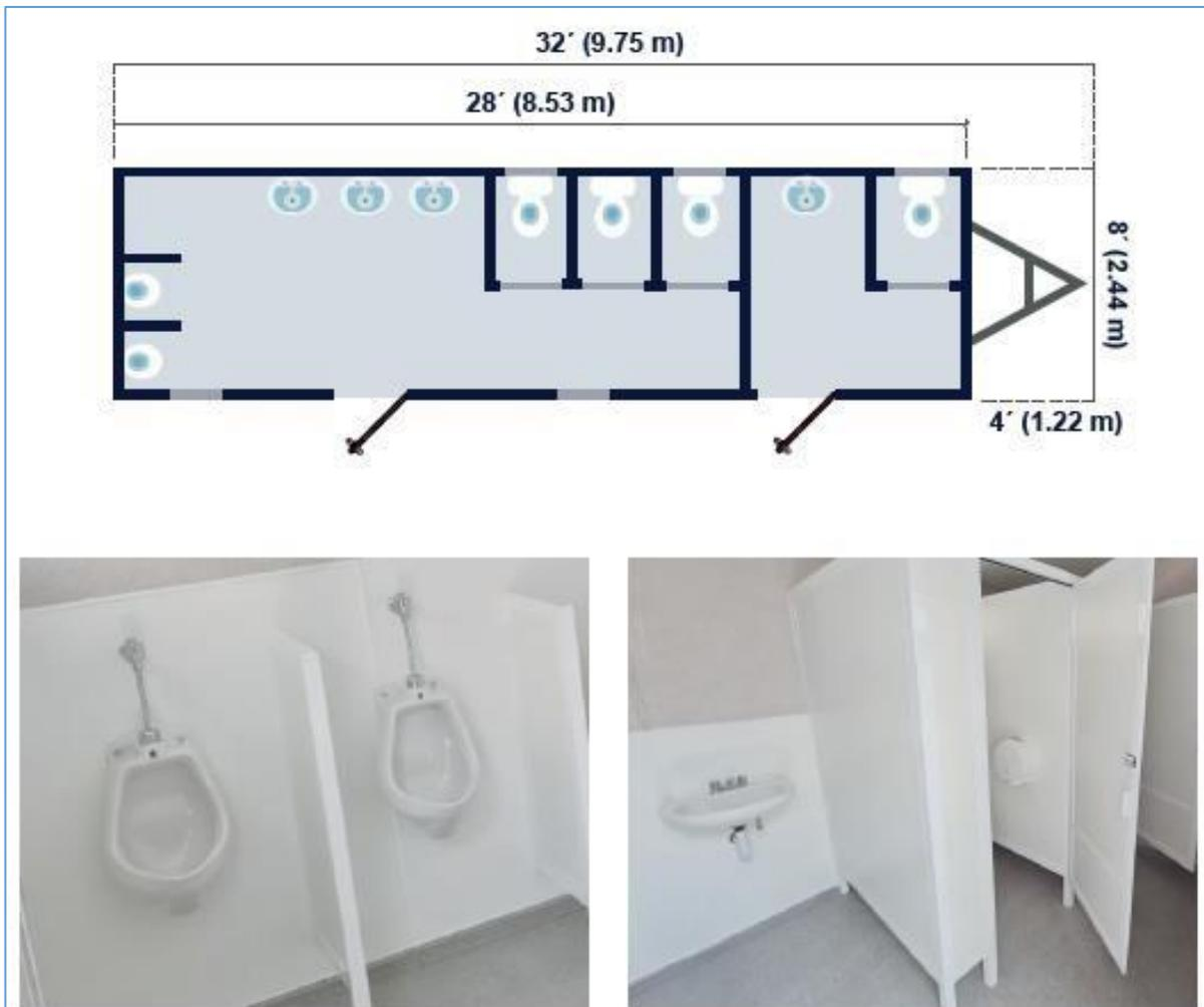
Ilustración II-14. Ejemplo del interior de la caseta de servicios sanitarios.
