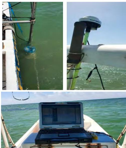
**Figura 49.** Montaje de equipo para medición de corrientes en modo dinámico. Doppler (superior izquierda), gps (superior derecha) y computadora de uso rudo (inferior).
