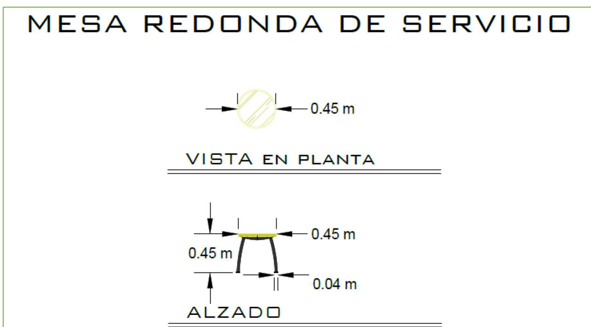
Ilustración 12. Corte y alzado mesas redondas de servicio.
