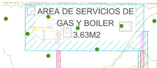
Figura 2.16. Imagen representativa del área de servicio de intaacion del gas LP y boiler.
