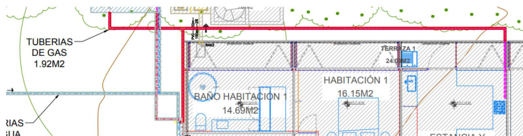
Figura 2.17. Imagen representativa del área para la intalacion de la tuberia de gas.
