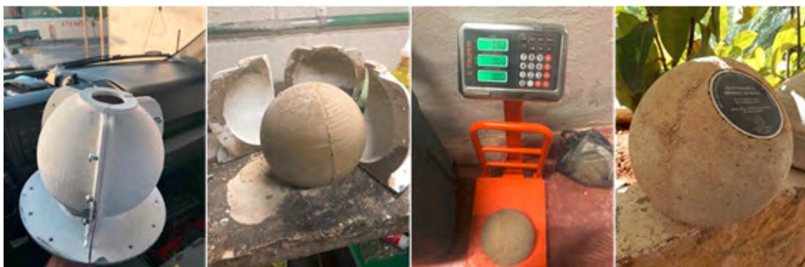
Figura II_ 15.- Proceso de elaboración de la perla memorial®, de izquierda a derecha: Molde, perla recién desmoldada, peso de la perla y perla finalizada.
