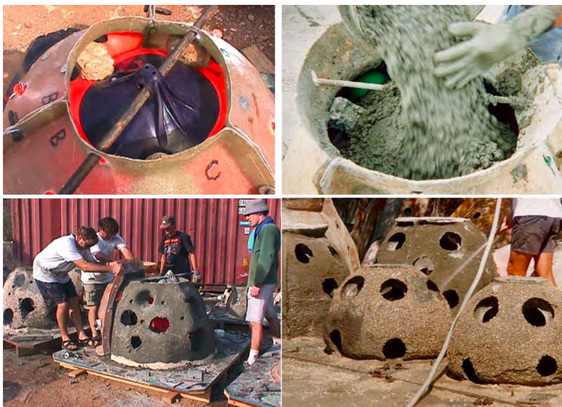
Figura II_ 11.- Proceso de fabricación de los Reef Ball®. Imagen tomada de Reef Ball Foundation®, https://www.reefball.org/
