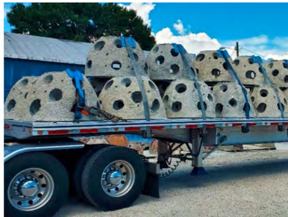
Figura II_16.- . Proceso de carga, transporte y descarga de estructuras de concreto Reef Ball®. Imágenes ilustrativas tomadas de otros proyectos e internet.
