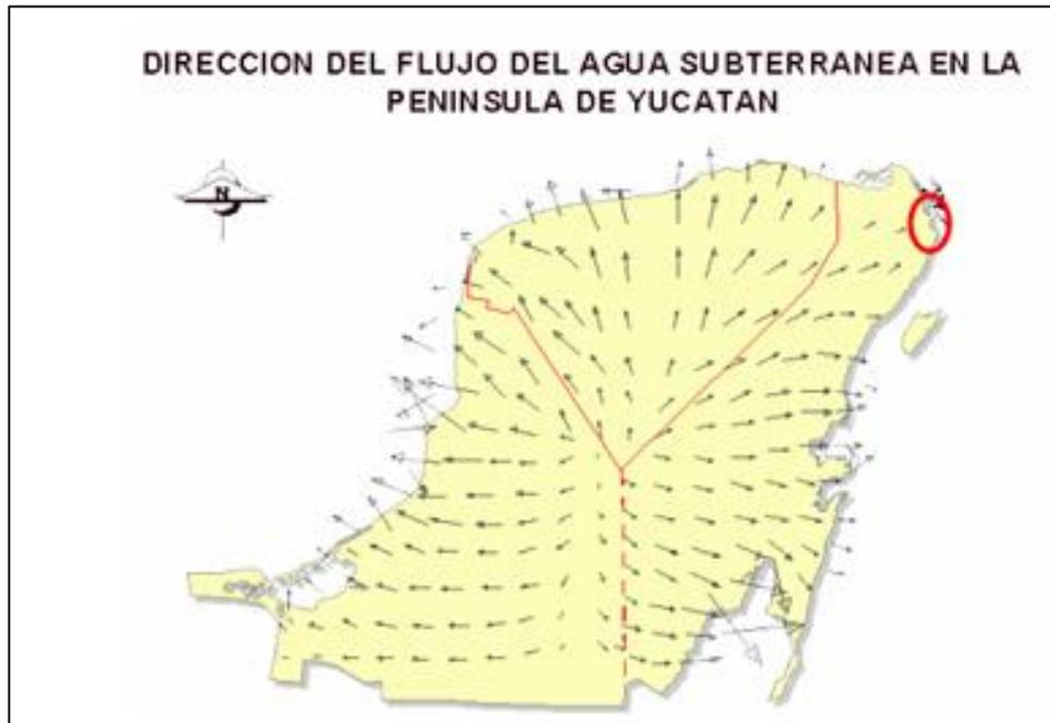
Figura 18. Flujo de aguas subterráneas. Las flechas indican la dirección del flujo y el círculo rojo el área del proyecto. (Modificado de CNA en línea)
