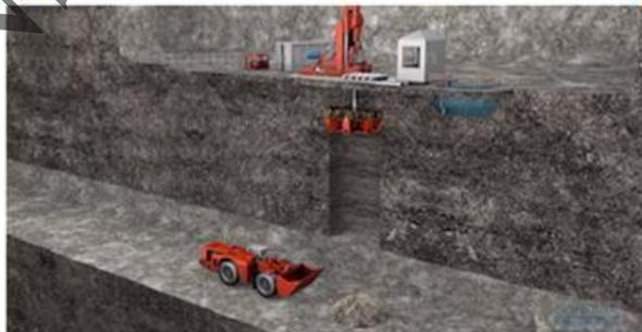
**Avance de la perforación del túnel de ventilación con ayuda de la rima**
