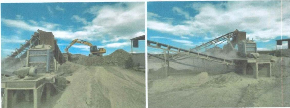
*Trituradora provisional instalada, para uso de piedra en la construcción de barda perimetral.*
