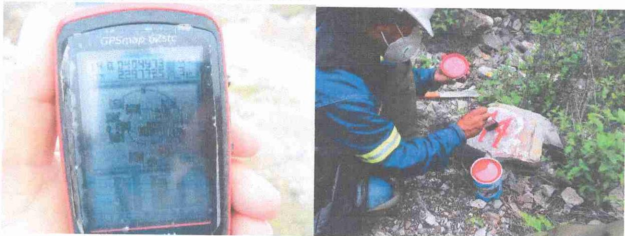
Imagen 3. Delimitación y señalización georreferenciada del área autorizada para cambio de uso de suelo en terrenos forestales correspondiente a las etapas 1, 2, 4 y 5 del proyecto.
