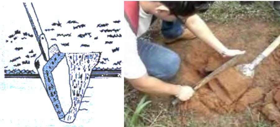
Figura 2. Modo correcto de tomar la muestra. Se elimina con un machete o cuchillo, las orillas del suelo que está en la pala y solo se utiliza lo del centro.
