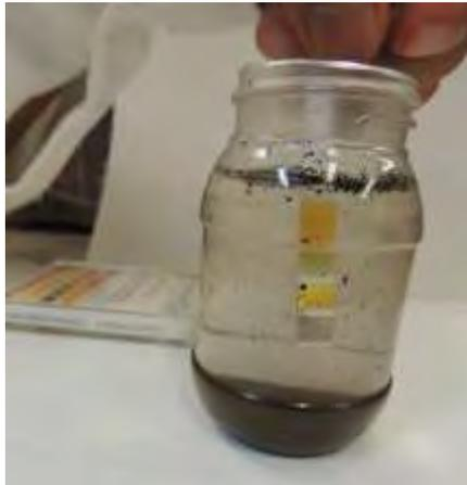
Figura 9. Forma correcta de tomar la medición, todos los cuadros de la tira indicadora, deben sumergirse en el agua de la muestra.
