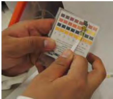
Figura 10. Comparación de la tira indicadora, con los colores de la caja, para obtener el resultado.
