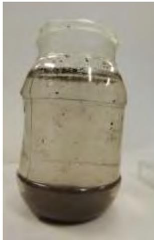
Figura 8. Suelo asentado, listo para realizar la medición.
