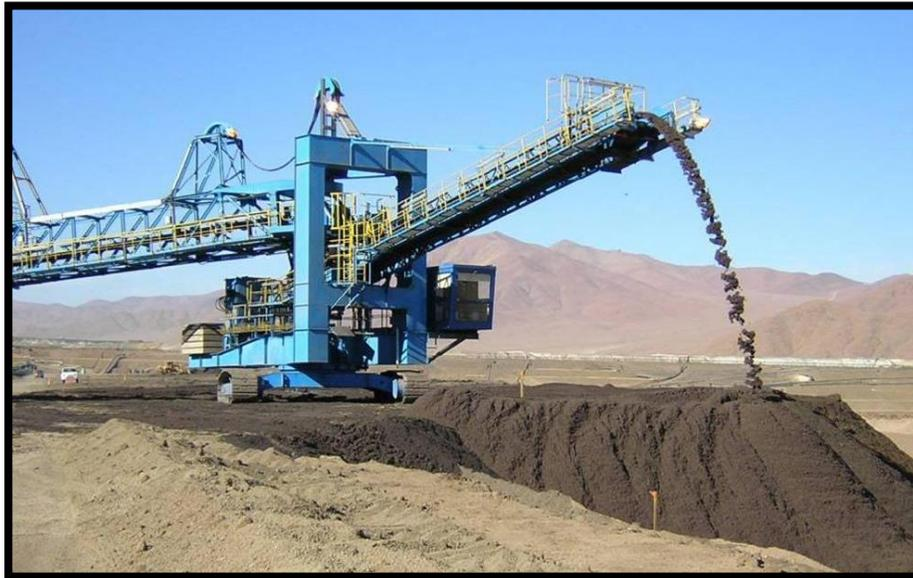
**Figura 8.** Uso de bandas transportadoras (stacker), para evitar daño por compactación en los liners por camiones pesados (yuckles).
