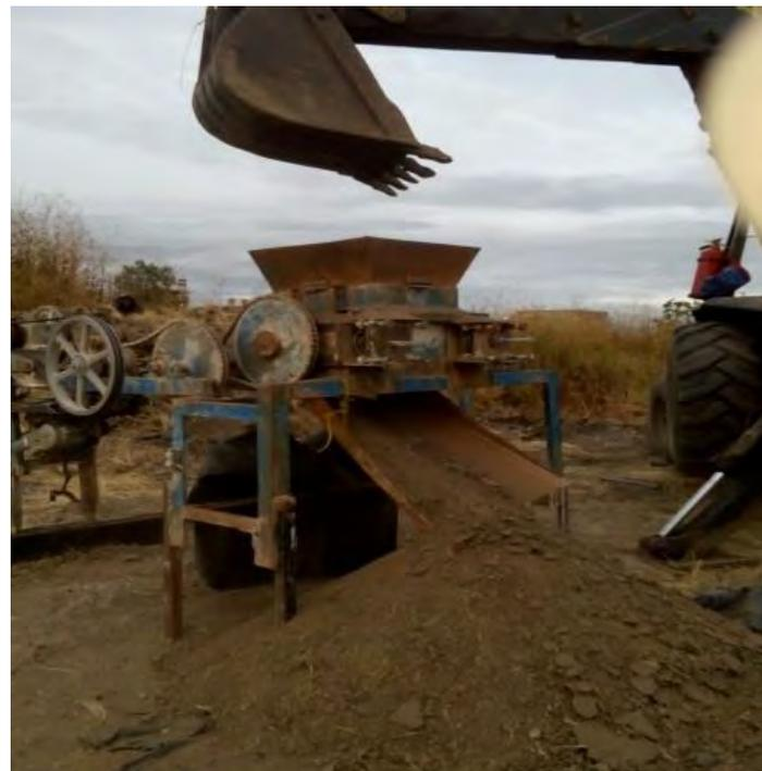
Figura 29. Suelo triturado por molino de rodillos.
