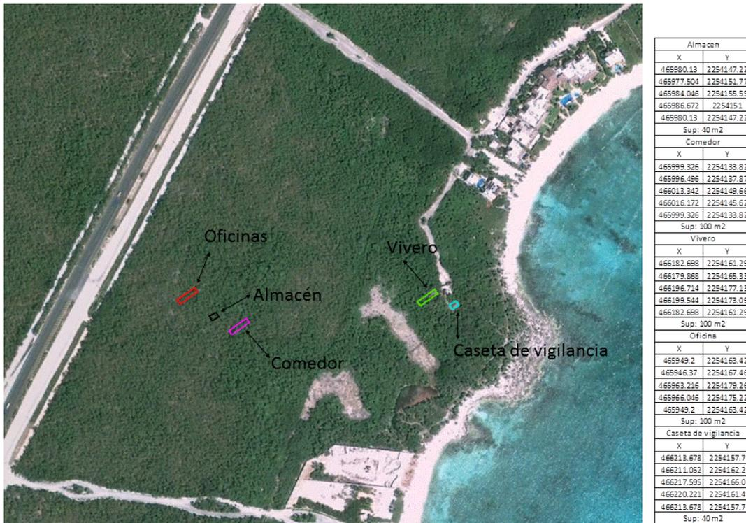
Figura II.4. Localización de las estructuras temporales, dentro del predio. En la figura se muestran las coordenadas de cada una de las instalaciones.
