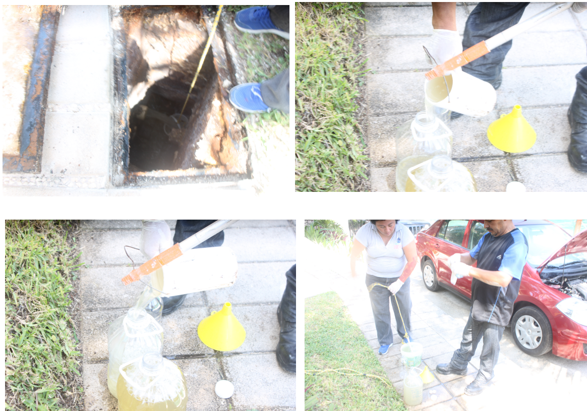
Figura II.4. Muestreo compuesto de los efluentes de Las Villas.
