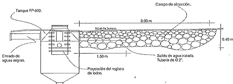
El campo de absorción tendrá las siguientes dimensiones: 3 m x 1.5 m. x 40 cm. de profundidad, una vez realizada la excavación, se implementará una cubierta impermeable (liner) y posteriormente se rellenará
