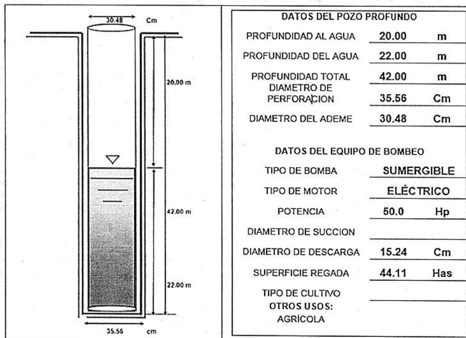
**RIEGO.** El agua se obtendrá de 12 pozos. Los pozos tendrán aproximadamente 42 m de profundidad. La bomba se instalará a cerca de 30 metros de profundidad. Cada pozo proporcionará un gasto máximo de 25.00 a 40.00 lt/ seg.. El agua se transportará desde cada uno de los pozos hasta la superficie de riego de cada rodal usando un sistema de tuberías superficiales. El diámetro de las
