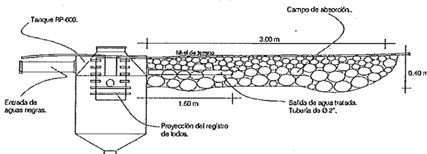
El campo de absorción tendrá las siguientes dimensiones: 3 m x 1.5 m. x 40 cm. de profundidad, una vez realizada la excavación, se implementará una cubierta impermeable (linner) y posteriormente se rellenará de grava hasta llegar al nivel del terreno, donde se podrá realizar la siembra de plantas nativas, con las características óptimas para el humedal, tales como las ciperáceas.
