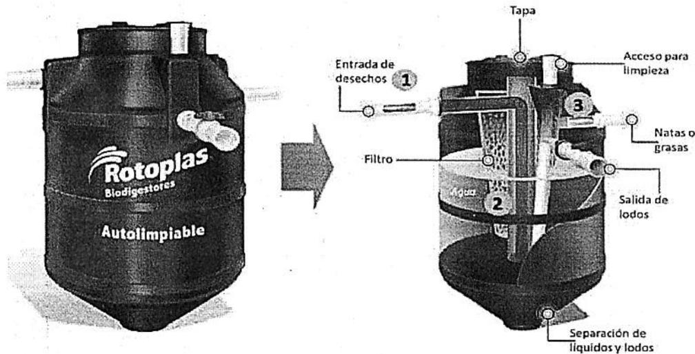
El funcionamiento del sistema Biodigestor, que se presenta en la figura 5, consiste en que el agua entra por un tubo (1) hasta el fondo, donde las bacterias empiezan la descomposición, luego sube una parte por el filtro (2).
