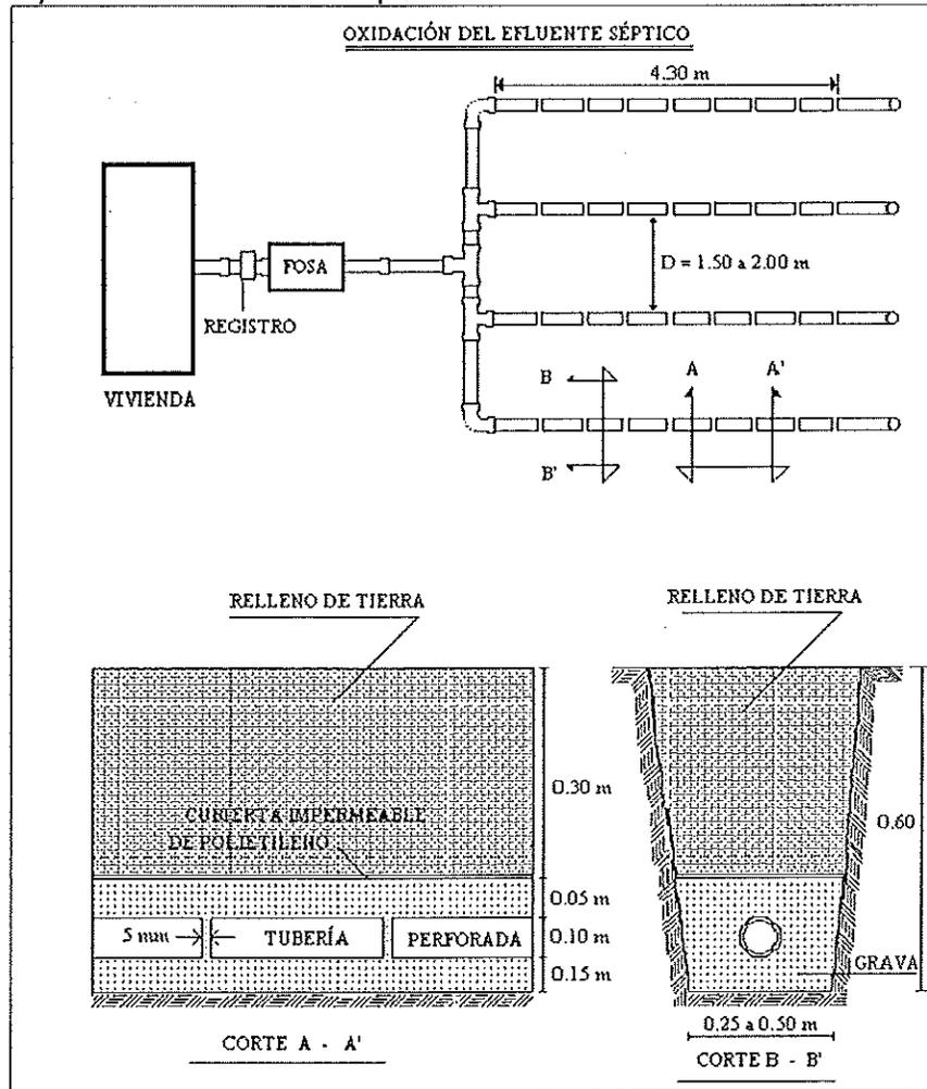
FIGURA 7. ZANJAS DE INFILTRACION
