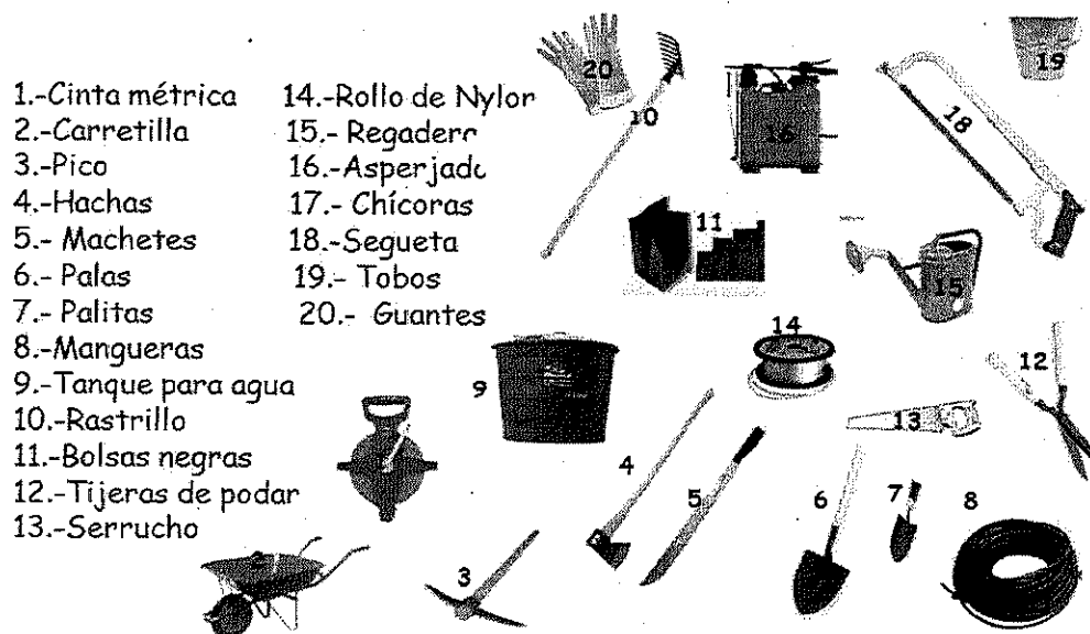
Herramientas y equipo básico para el rescate y mantenimiento en sitio de acopio
