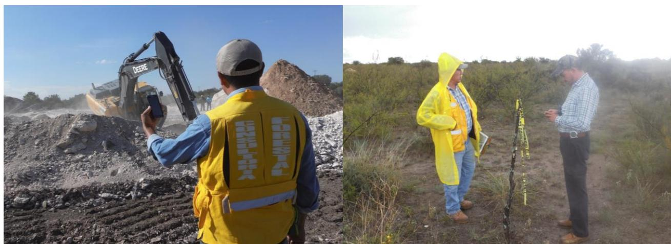
Figura 8. Medición de los niveles de ruido (izquierda: banco de material en operación, derecha: área del proyecto en sus condiciones naturales).
