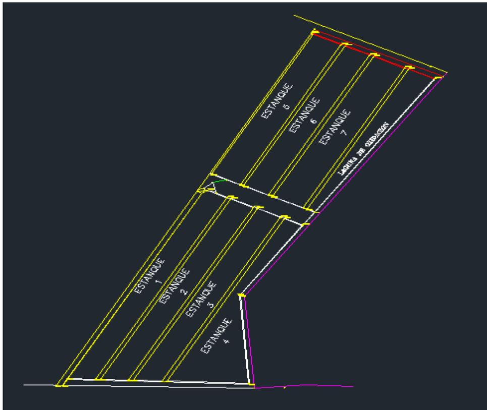
b) Estanques para preengorda, engorda, aclimatación y manejo sanitario, canal de abastecimiento, dren de descarga, canales de distribución y cárcamo de bombeo.
