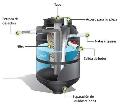
**Figura 2.13** Biodigestor sugerido
