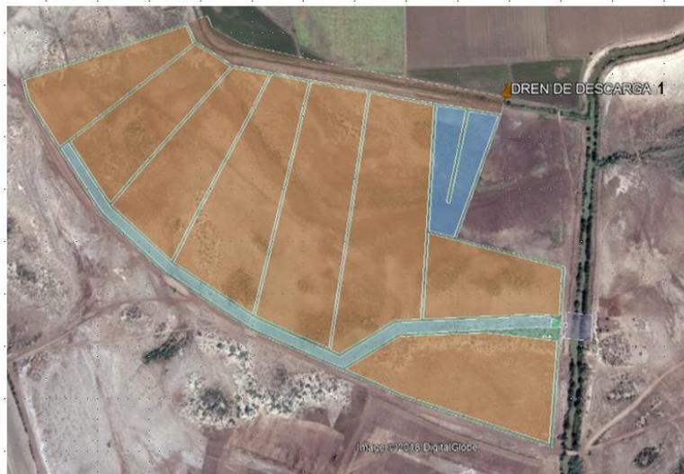
Dicho dren de descarga mantendrá una profundidad promedio a los 2.20 Metros. El dren fue construido en su momento a base de préstamos laterales, producto de la misma excavación.
