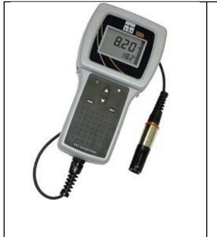
Figura 8. Oxímetro de campo con sonda.
