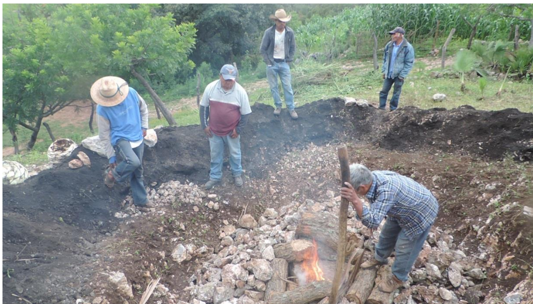
Figura 28. Encendido del horno y colocación de piedras.
