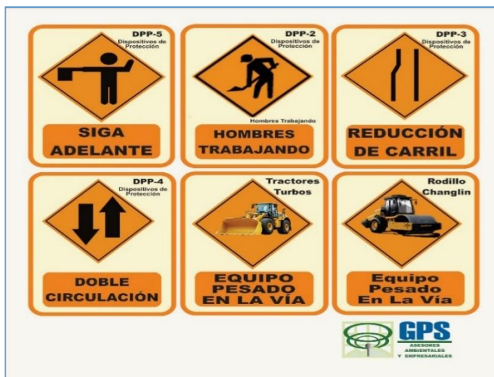
Ilustración 8. Señalizaciones de hombres trabajando
