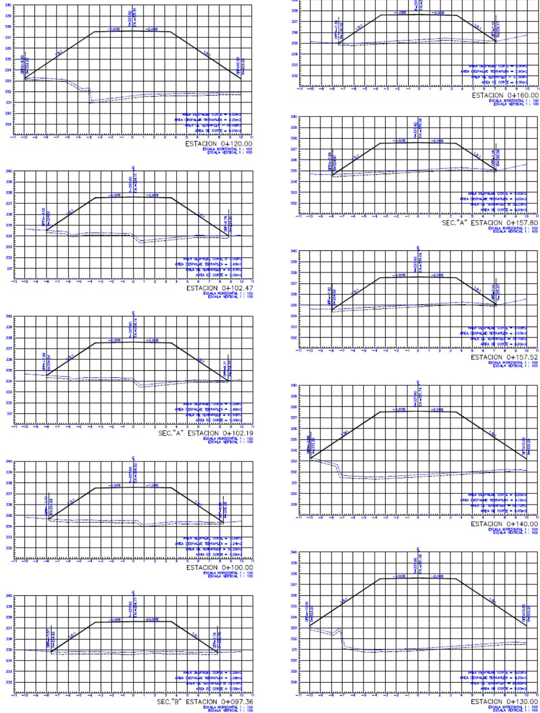
Imagen 18. Secciones del proyecto del Km 0+097.36 al Km 0+162.55
