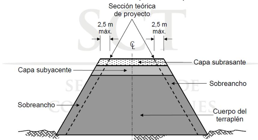
Imagen 31. Sección transversal de un terraplén
