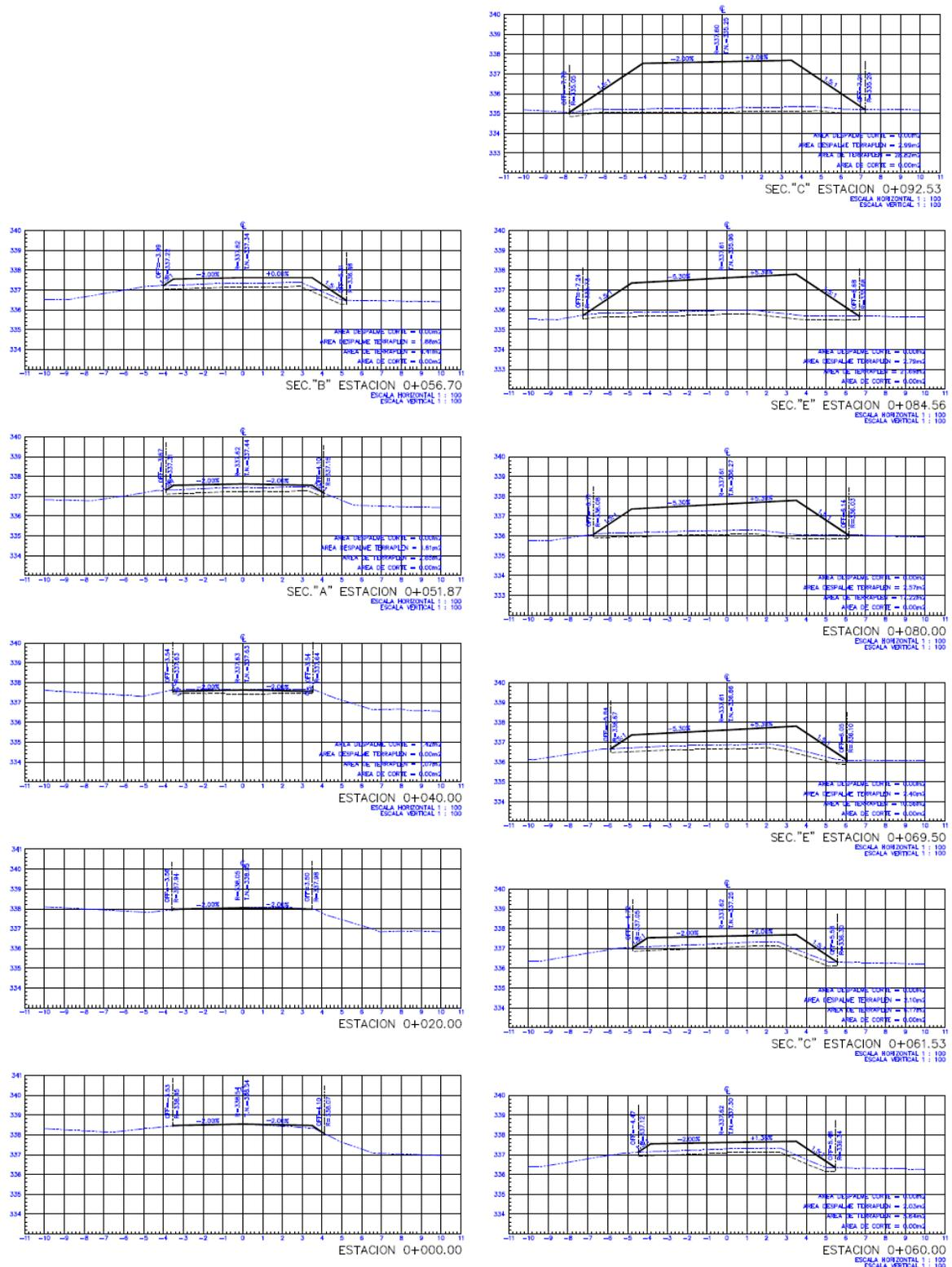
Imagen 17. Secciones del proyecto del Km 0+000 al Km 0+092.53
