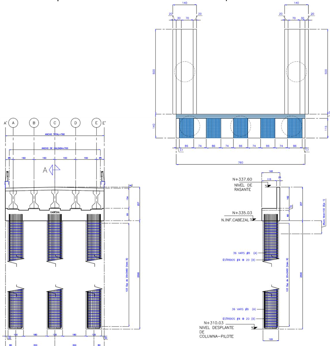
Imagen 13. Elevación y Planta con medidas de Subestructura del Eje 1 del Puente Vehicular
