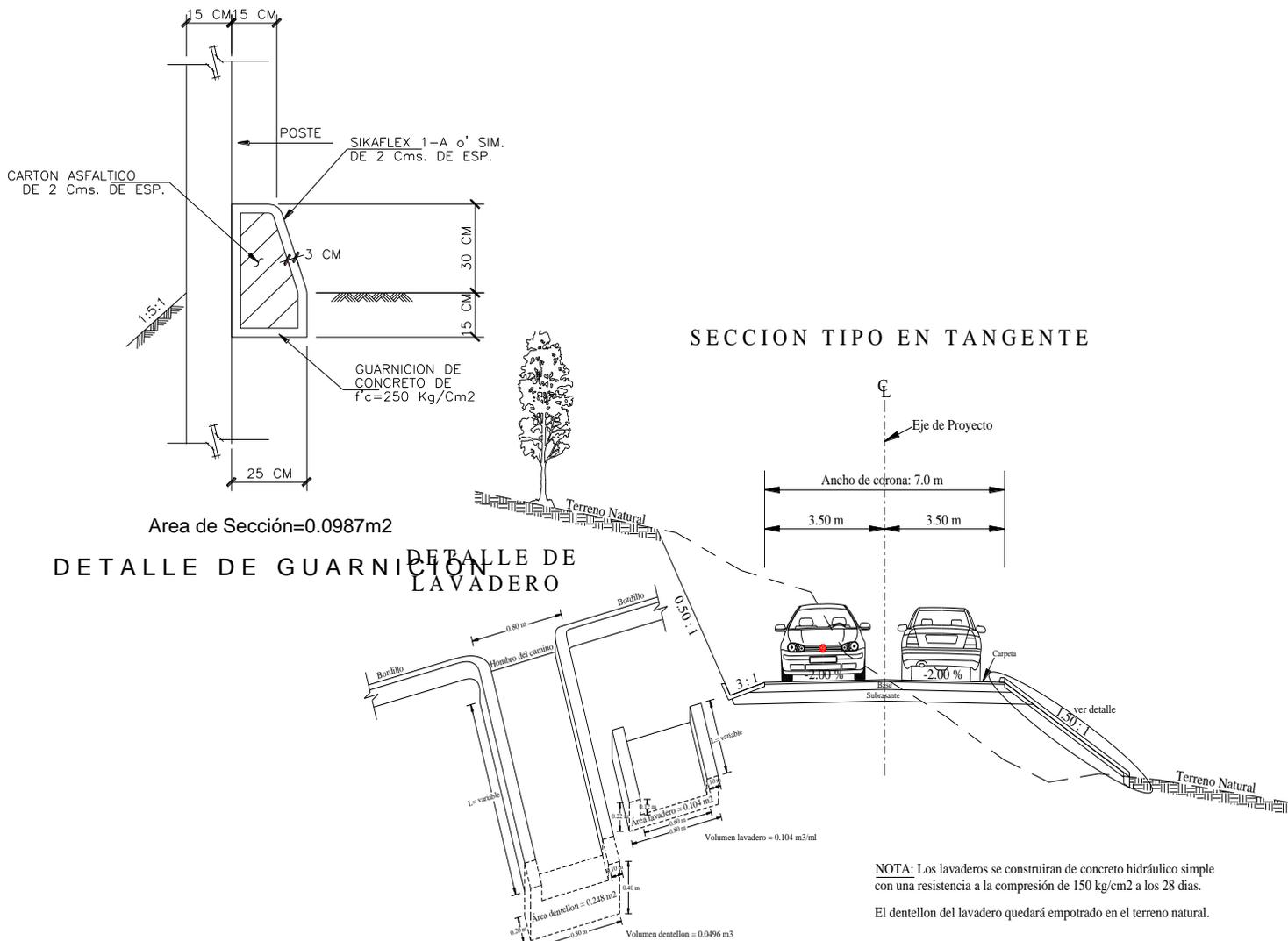
*Imagen 32. Diseño representativo de las guarniciones y lavaderos ubicados en las rampas de acceso del Proyecto*
