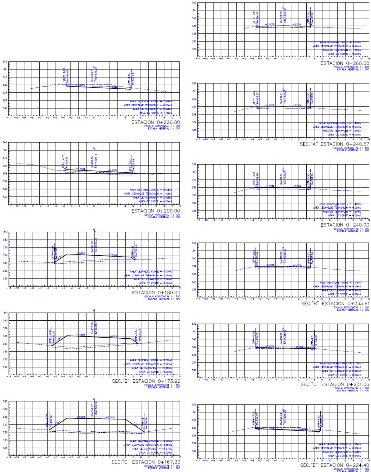
Imagen 19. Secciones del proyecto del Km 0+167.30 al Km 0+260.0
