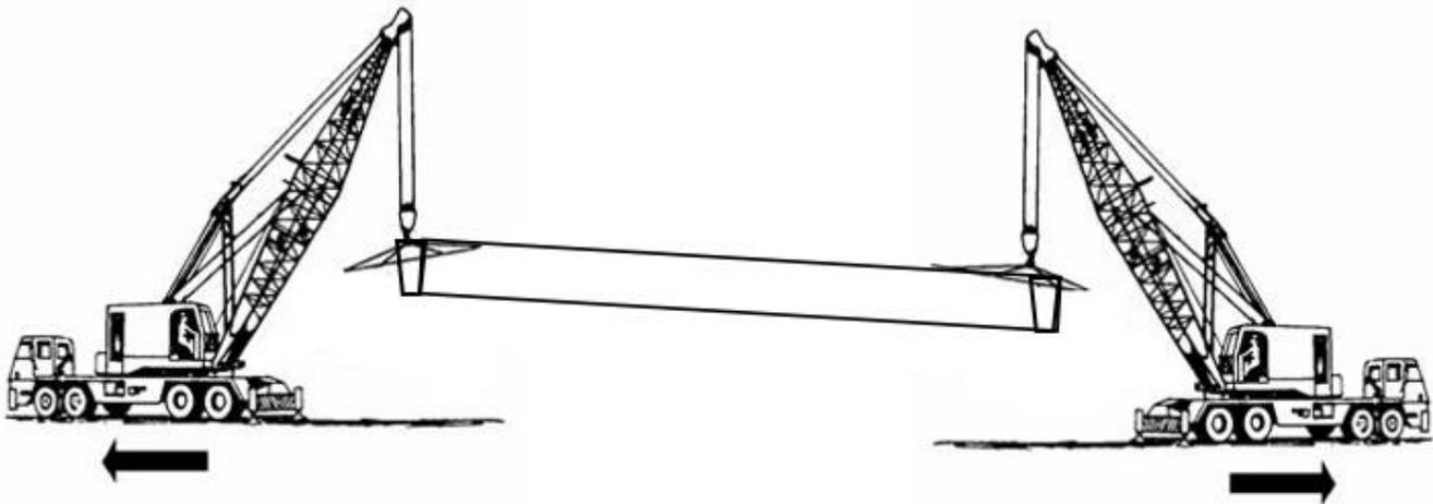
*Imagen 30. Proceso de montaje con 2 grúas*
