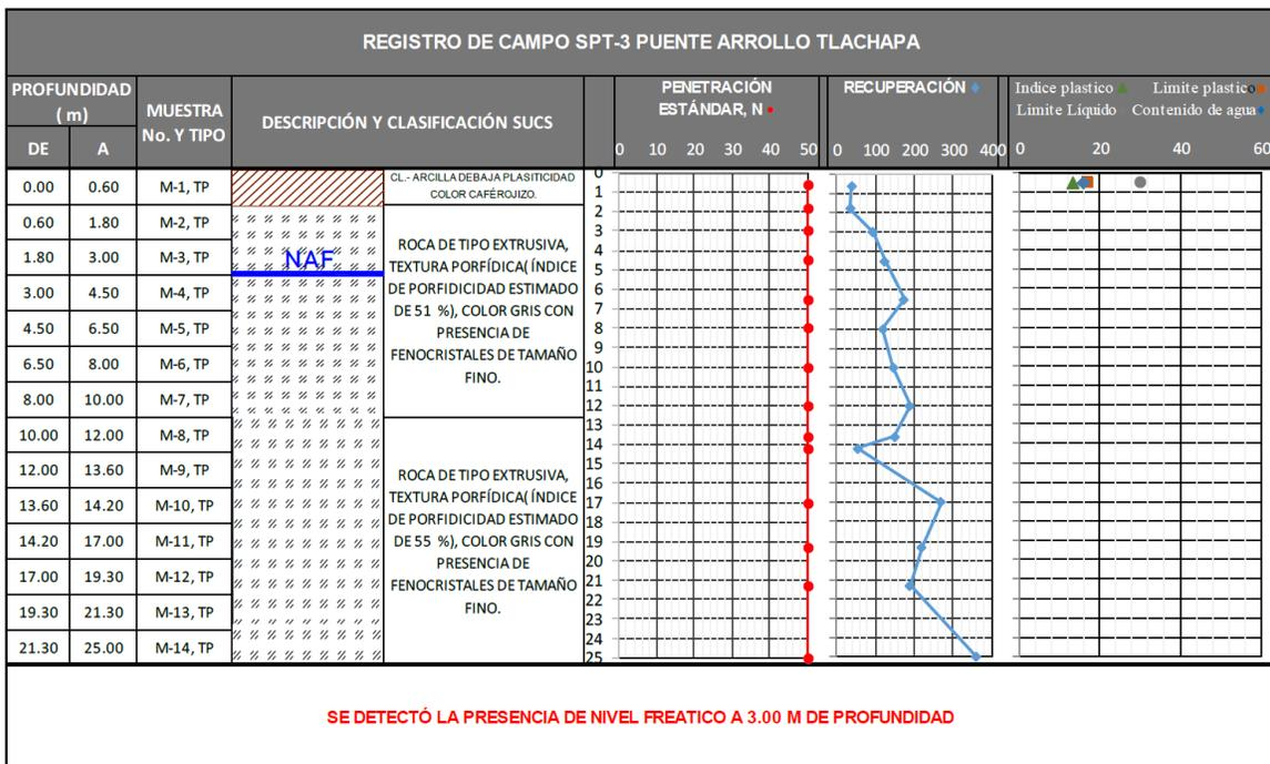
Imagen 26. Perfil estratigráfico del Sondeo de Penetración Estándar número, SPT-2 y SPT-3, tomado de Estudio de Mecánica de Suelos, elaborado por PUENTES Y CONSTRUCCIONES MESI S.A. DE C.V.
