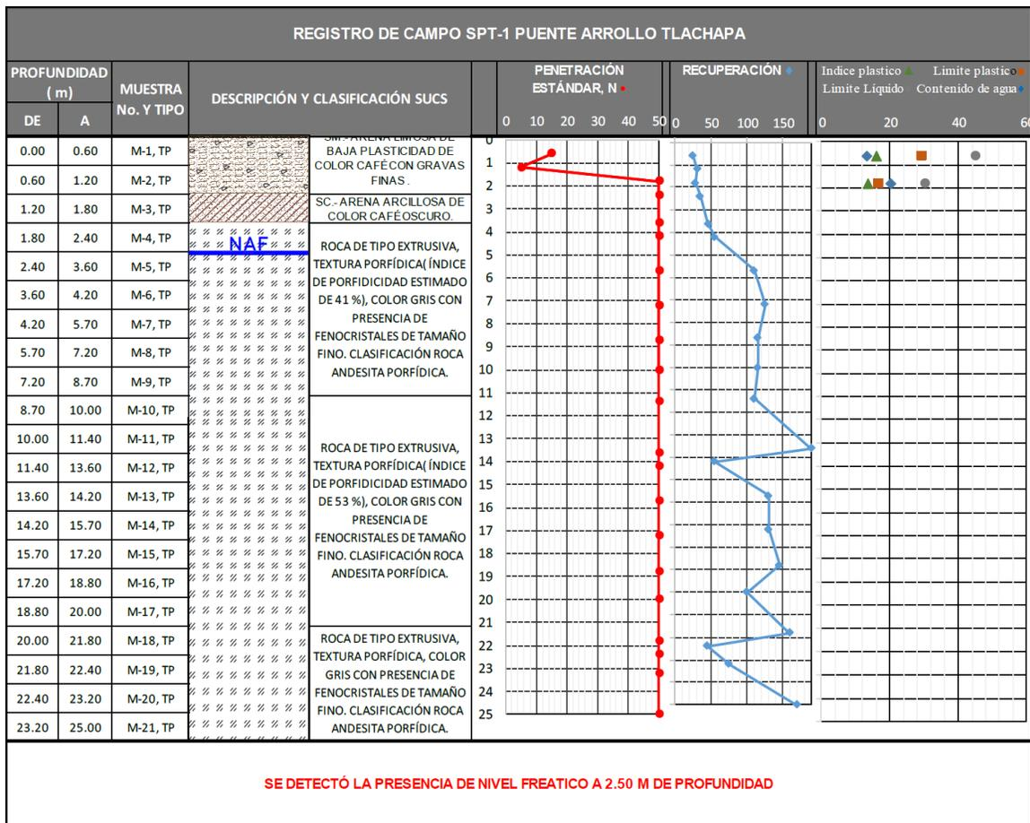
Imagen 30. Perfil estratigráfico del Sondeo de Penetración Estándar número, SPT-1, tomado de Estudio de Mecánica de Suelos, elaborado por PUENTES Y CONSTRUCCIONES MESI S.A. DE C.V.
