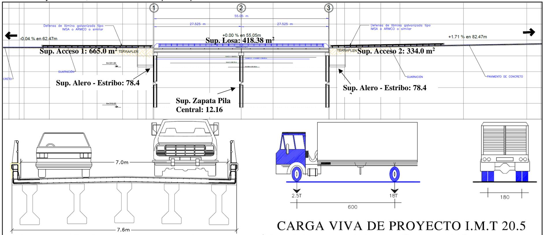
Imagen 11. Vista longitudinal y transversal con las características de las rampas de Acceso y Estructura del Puente
