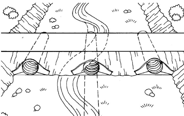
*Imagen 22. Vista representativa de la Instalación de alcantarillas dentro de un cauce amplio; tomado de Gordon Keller y James Sherar, 2004.*
