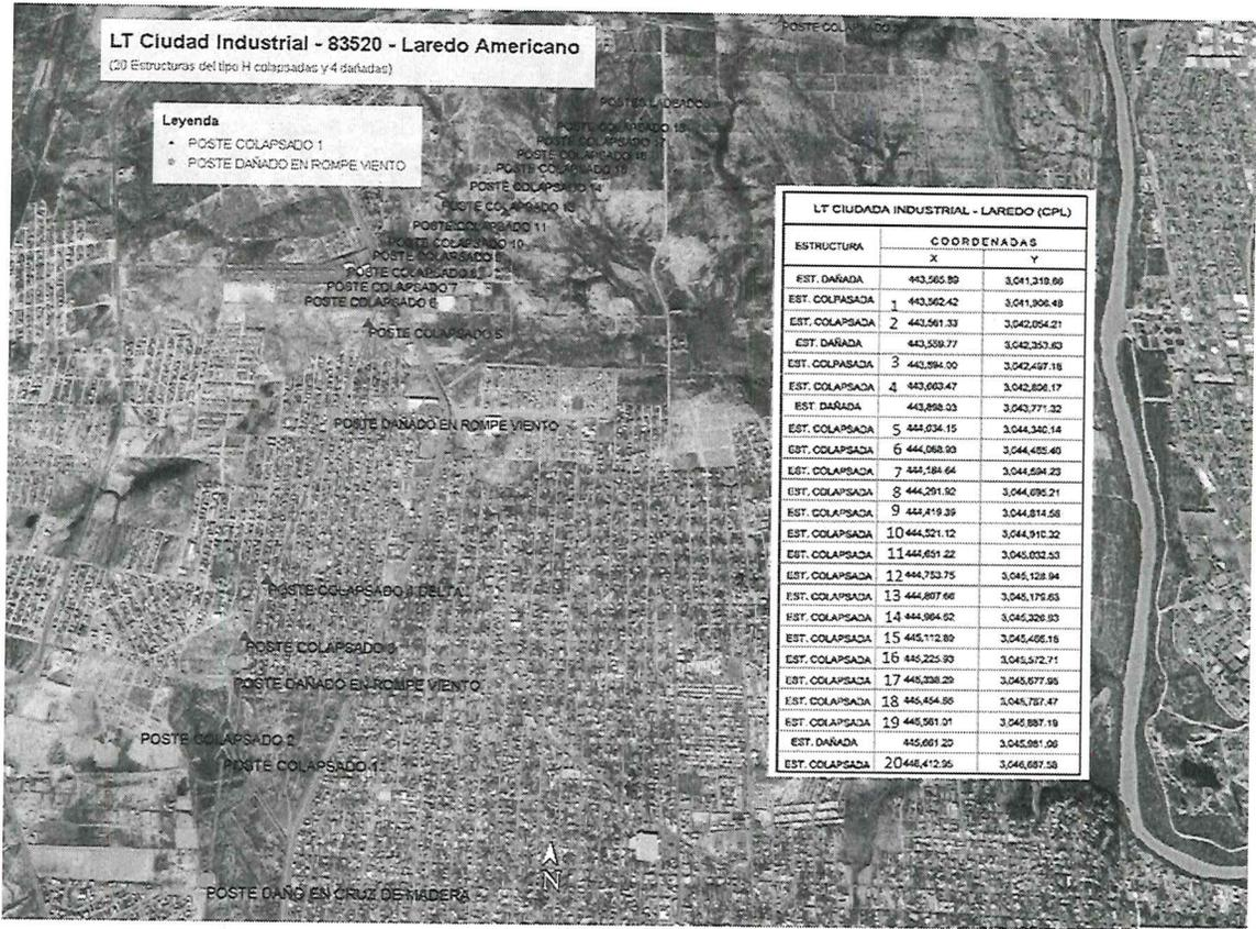
Imagen 4.- Ubicación de la LT Ciudad Industrial - 83520 - Laredo Americano, donde se pueden observar los sitios de c/u de los postes dañados y colapsados
