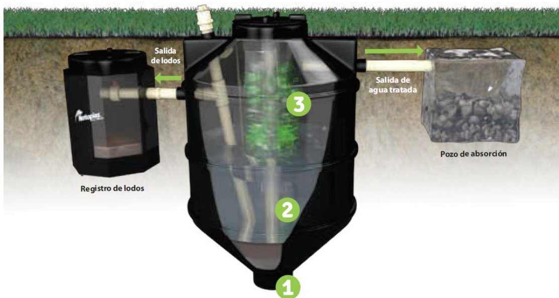
Figura 20. Funcionamiento del biodigestor autolimpiable
