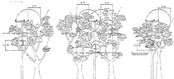
Figura 5.- Para promover una poda adecuada se debe respetar la vegetación colindante procurando que la poda considere retirar las ramas que se puedan encontrar dentro de los 2 metros próximos al conductor.
