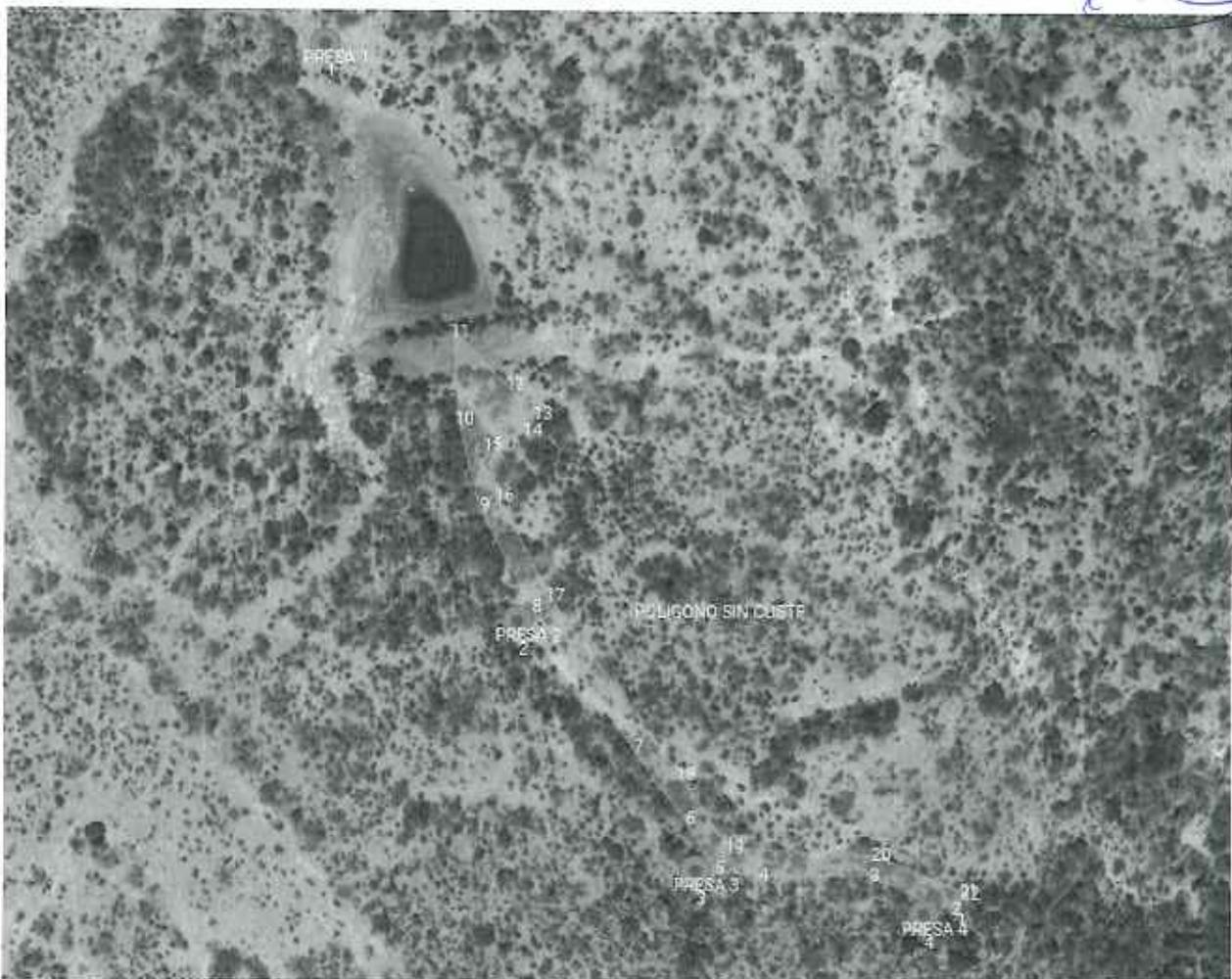
**Figura 5.** Imagen satelital que se obtiene al georreferenciar las coordenadas del Polígono en el que **no se realizará CUSTF** y la Presas Filtrantes, con pretendida ubicación dentro y fuera de la Zona Federal del Arroyo Innominado.
