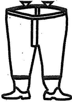
BOTA TIPO PANTALONERA, CON PETO AHULADO Y TIRANTES AJUSTABLES, VULCANIZADOS A LA BOTA, SEGÚN CORRESPONDA EL TIPO DE MATERIAL (LO QUE LA HACE DE UNA SOLA PIEZA), CON UNA ALTURA PROMEDIO DE 90CMS. PROPORCIONAL A LA TALLA.
