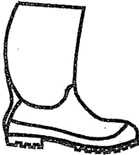
BOTA IMPERMEABLE DE SEGURIDAD, FABRICADA DE HULE CON UNA ALTURA DE 40CM PROMEDIO, MEDIDOS DESDE EL PISO AL PUNTO MÁS ALTO DEL LA BOTA, VULCANIZADA EN UNA SOLA PIEZA, CON SUELA DE HUELLA ANTIDERRAPANTE Y CON SALIDAS PARA LÍQUIDOS Y RESIDUOS DE MATERIALES, CON FORRO INTERIOR DE TELA 100% ALGODÓN PARA LA ABSORCIÓN DEL SUDOR, CON PUNTERA Y TALÓN REFORZADOS CON LAS SIGUIENTES CARACTERÍSTICAS:
