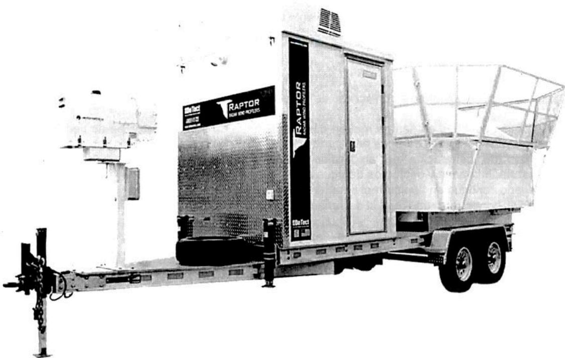
Ejemplo que ilustra un Radiómetro de Radiometrics en un Sistema de medición móvil en un Remolque.
