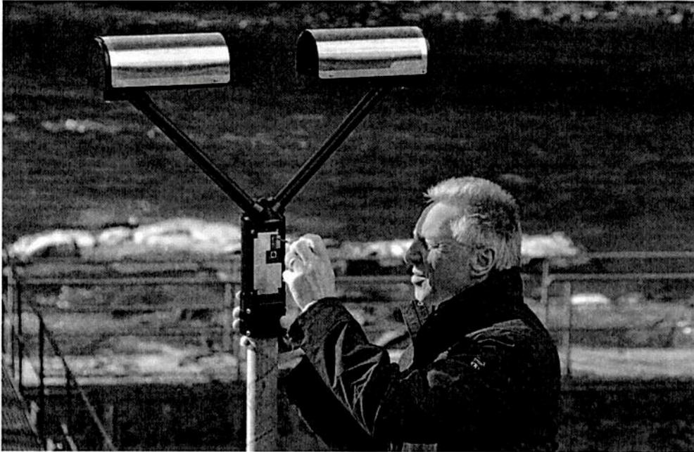
Disdrometro OTT Parsivel 2 instalado en un sitio bajo operación remota
